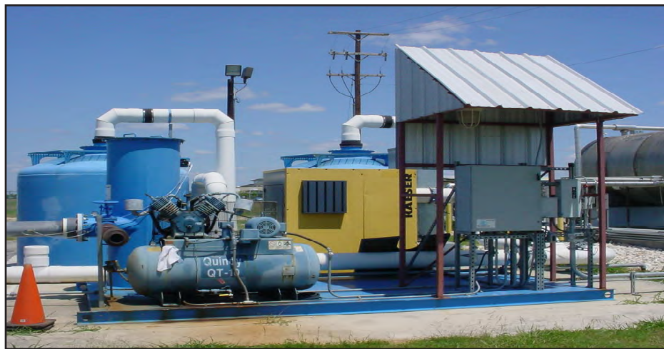
Un sistema de extracción de vapor en la tierra usado en la antigua base aérea Kelly.
